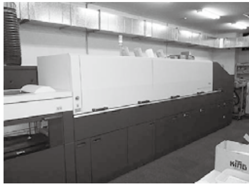
「NexPress SX3300」。5胴目でゴールドやクリアトナーを使うことで高付加価値印刷も可能にしている
